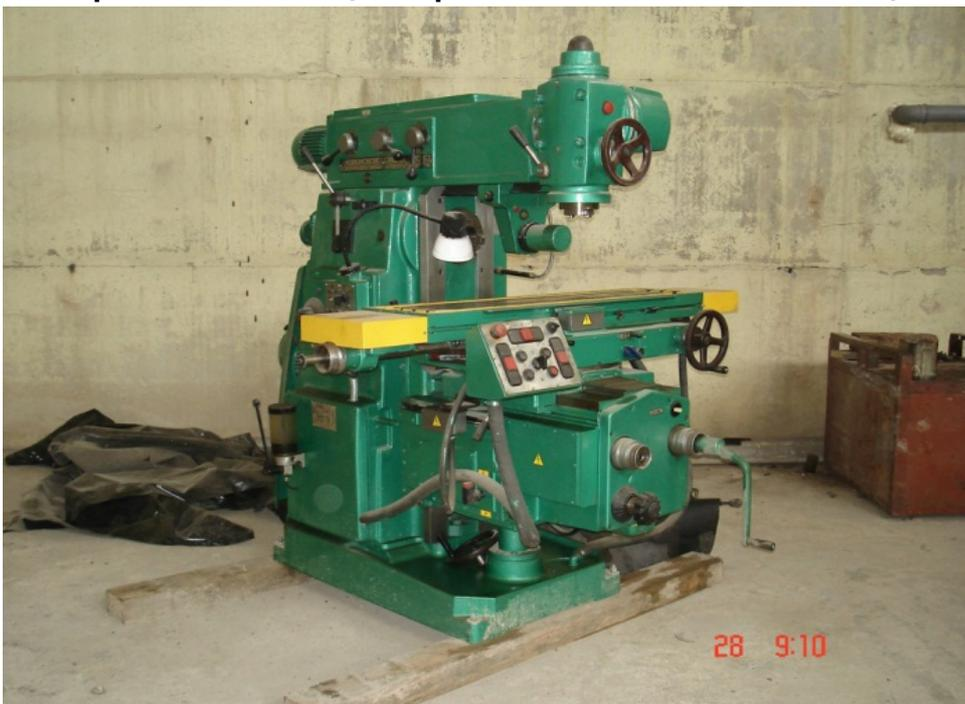
Широкоуниверсальный фрезерный станок 6Т82Ш предназначен для выполнения разнообразных фрезерных, сверлильных и расточных работ цилиндрическими, торцевыми, концевыми, фасонными и другими фрезами. Применяются для обработки горизонтальных и вертикальных плоскостей, пазов, рамок, углов, зубчатых колес, спиралей, моделей штампов, пресс-форм и других деталей из стали, чугуна, цветных металлов, их сплавов и других материалов.
